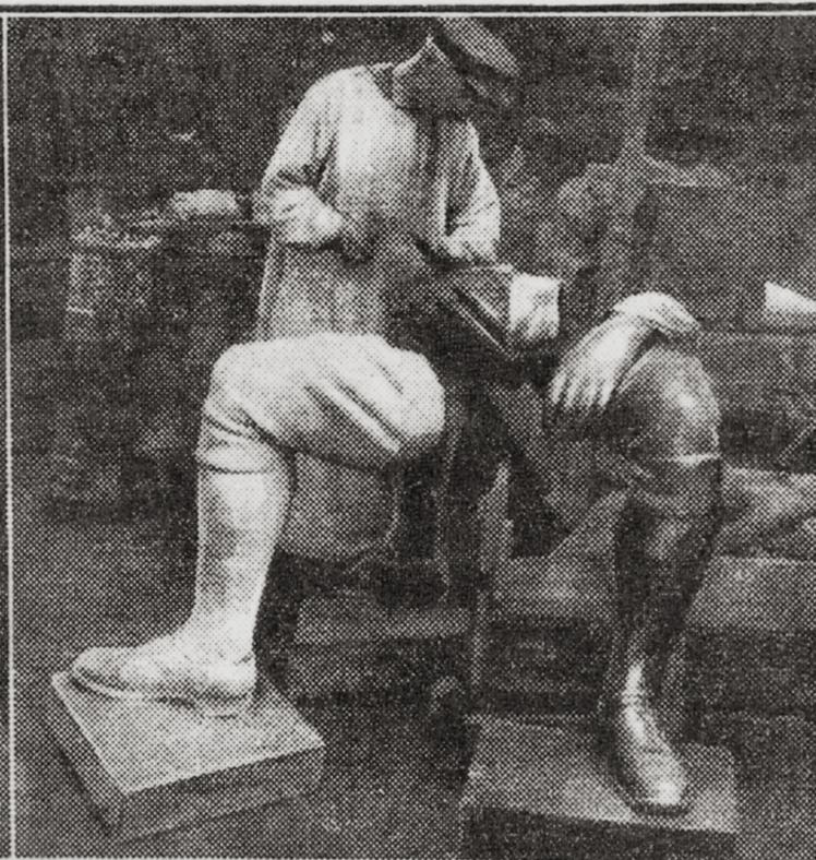
Chaque élément du « moule en creux » est renforcé extérieurement et, la fonte achevée, il ne reste plus, avant l'assemblage, qu'à corriger les bavures du bronze d'après le modèle de plâtre
